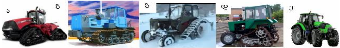
სურ. 1. ტრაქტორები ურთიერთ განსხვავებული სავალი ნაწილით: ა-ოთხი მუხლუხა სავალი ნაწილით, ბ-მუხლუხა, გ-ნახევრადმუხლუხა, ე-თვლიანი.
