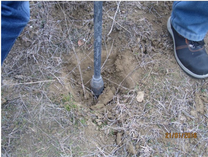
ნახ. 3. დამეწყრულ ფერდობზე ნიადაგ-გრუნტის ნიმუშის აღების პროცესი
