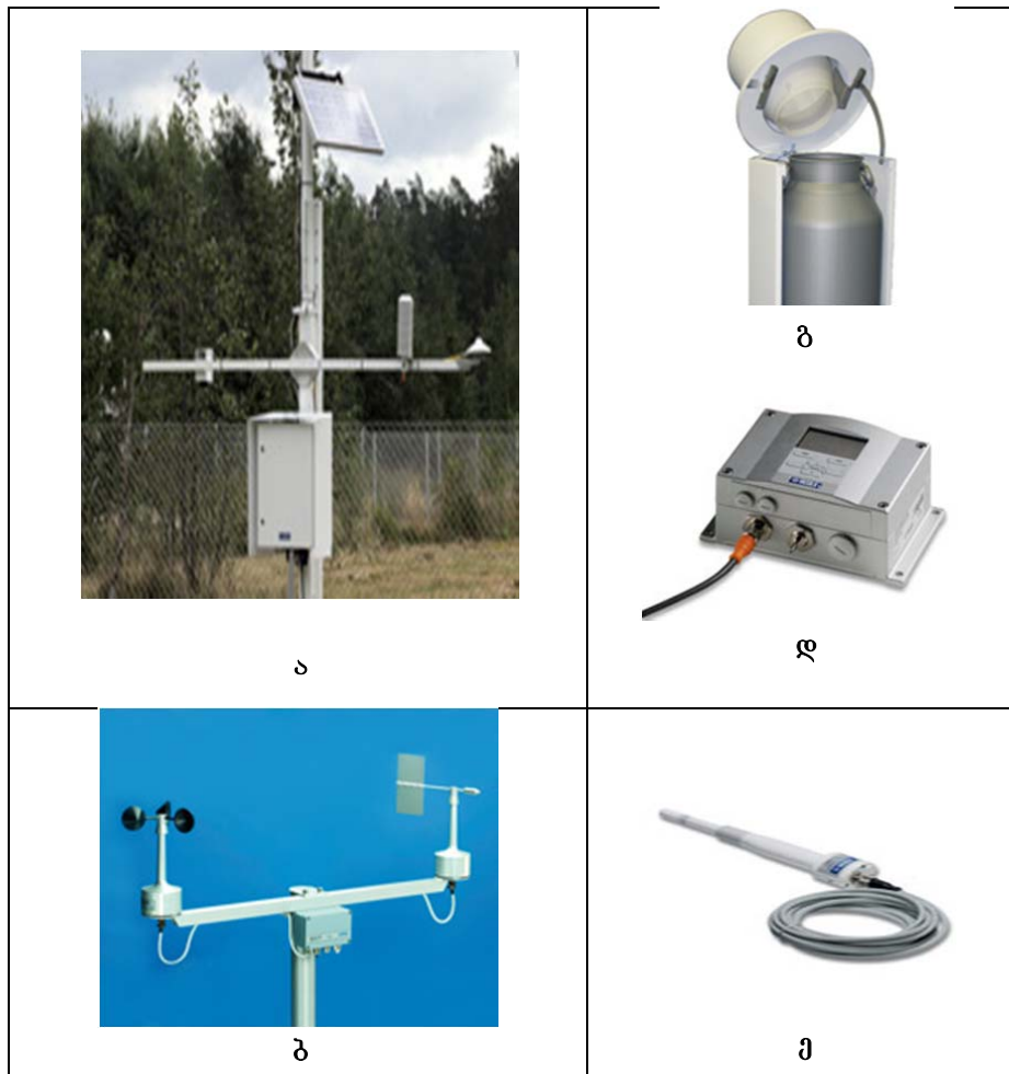
ნახ. 2. ავტომატიზებული მეტეოსადგური (ა) და მისი შემადგენელი ნაწილები: ქარის სიძლიერისა და მიმართულების განმსაზღვრელი სენსორი (ბ); ნალექსაზომი(გ); წნევის სენსორი (დ); ჰაერის ტემპერატურისა და სინოტივის საზომი სენსორი (ე)
