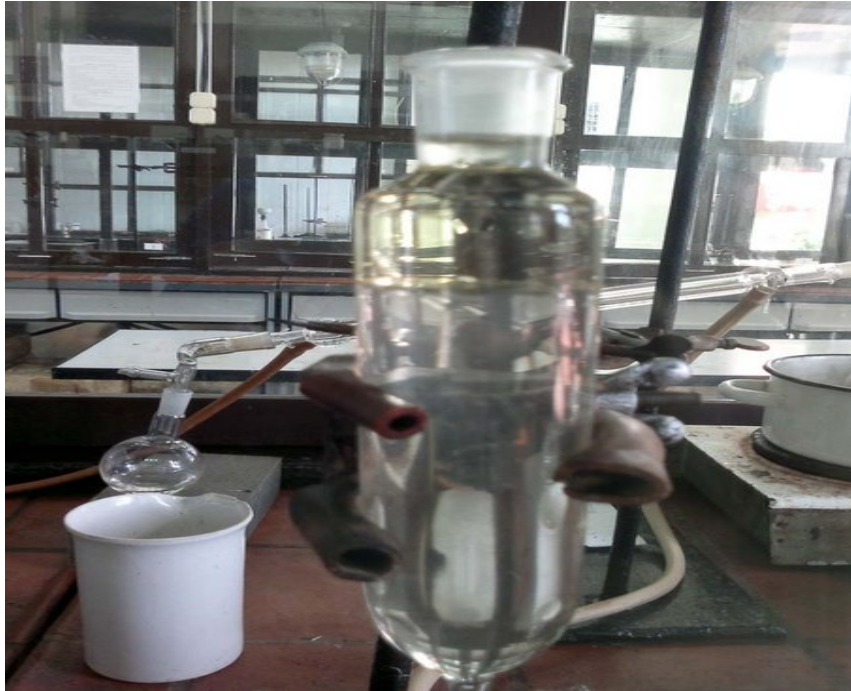
ნახ. 2. კოფეინის მისაღები ლაბორატორიული აპარატურა
