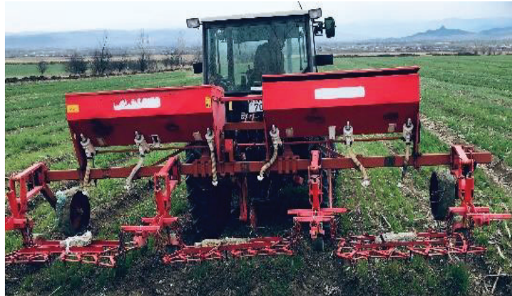
. სურ.1. მოდერნიზირებული რიგთაშორისების კულტივატორი „ლგმკ-4,5/3“
